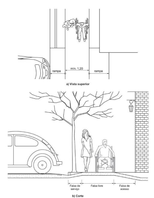
Figura 4 - Corte com as faixas de uso da calçada (dimensões em metros) Fonte: ABNT (2021)
