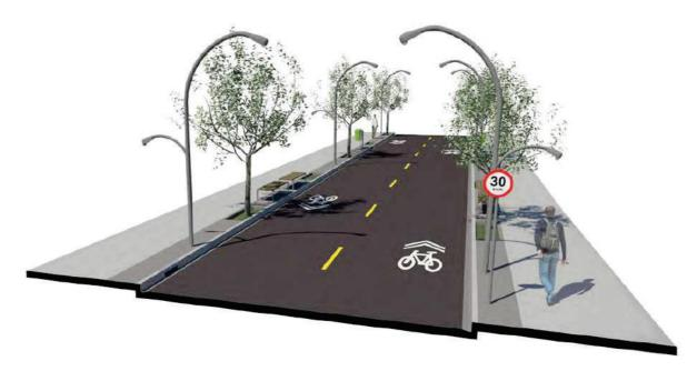
Figura 23 - Sinalização do tipo sharrow, indicada para ciclorrotas Fonte: Caderno técnico para projetos de mobilidade urbana (Brasil, 2017, p. 41)
