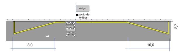
Figura 42 – Sinalização horizontal da área reservada para parada de ônibus (medidas em metros) Fonte: CET (2001)
