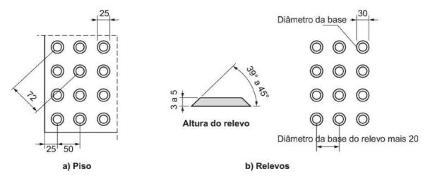
Figura 18 - Sinalização tátil de alerta e relevos táteis de alerta (dimensões em milímetros) Fonte: ABNT (2016, p. 6)
