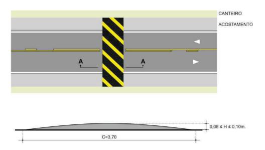
CORTE A-A Figura 50 - Lombada de corte A-A Fonte: Brasil, Contran. Resolução nº 600/2016.
