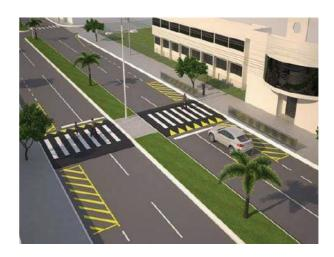
Figura 47 - Sinalização horizontal e vertical para travessia elevada de pedestres Fonte: Brasil, Contran. Resolução nº 738/2018.
