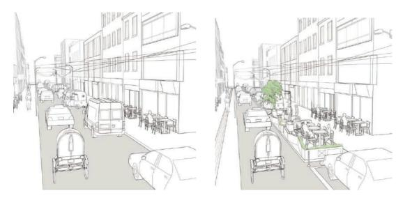
Figura 9 – Exemplo de remodelação de via a partir de implantação de Parklet Fonte: NACTO (2018)
