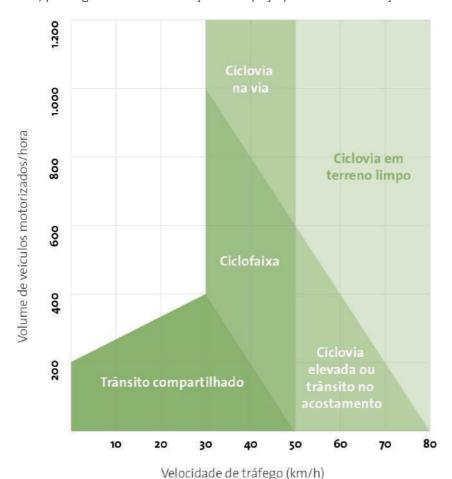
Figura 22 - Nível de segregação cicloviária de acordo com a velocidade e o fluxo da via Fonte: BID e MDR (2020d, p. 60)
