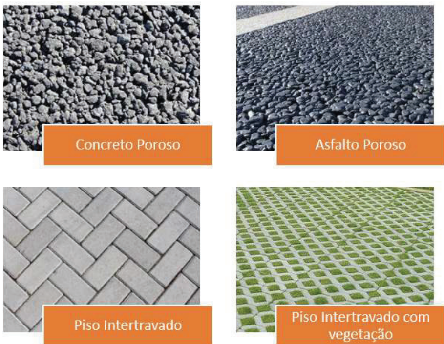
Figura 44 – Tipos de pavimentos permeáveis Fonte: Aguiar (2022)
