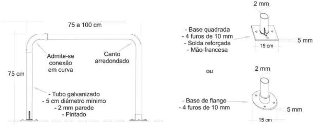
Figura 26 - Modelo de paraciclo parafusado no pavimento. Fonte: UCB (2017a, p. 13)
