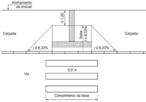
Figura 16 - Rebaixamentos de calçada — Vista superior (dimensões em metros) Fonte: NBR 9050:2021 (2021, p. 79)
