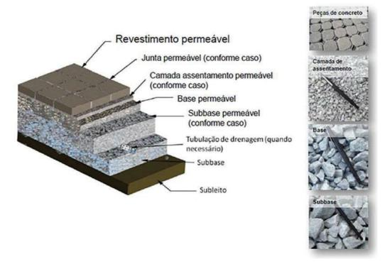
Figura 43 - Seção-tipo típica de pavimento intertravado permeável. Fonte: Associação Brasileira de Cimento Portland (2011)
