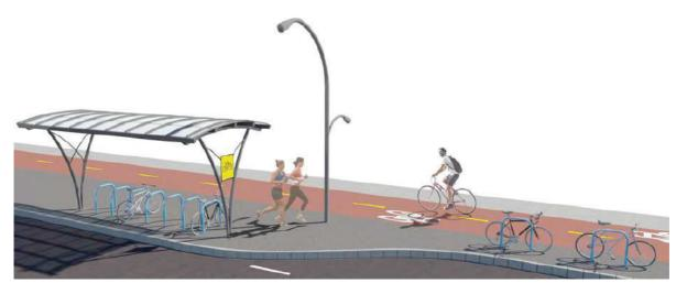
Figura 28 - Instalação de paraciclos em paralelo (esq.) e em linha (dir.) Fonte: Brasil (2017, p. 49)
