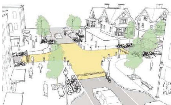
Figura 53 - Perspectiva de implantação de travessia elevada (esq.) e travessia leito carroçável elevado em cidade do exterior (dir.)
