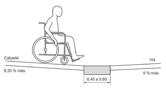
Figura 17 - Faixa de acomodação para travessia — Corte (dimensões em metros) Fonte: NBR 9050:2021 (2021, p. 79)
