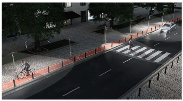
Figura 13 - Iluminação específica para pedestres e ciclistas. Fonte: MTB Brasília (2015)
