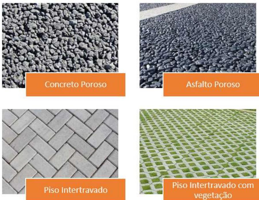
Figura 44 – Tipos de pavimentos permeáveis
