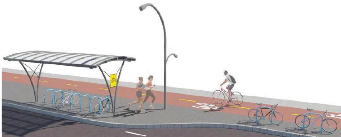
Figura 28 - Instalação de paraciclos em paralelo (esq.) e em linha (dir.)
