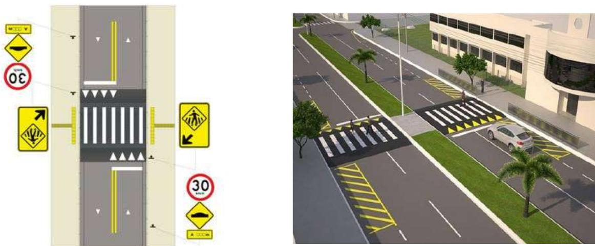
Figura 47 - Sinalização horizontal e vertical para travessia elevada de pedestres
