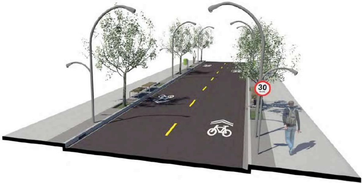
Figura 23 - Sinalização do tipo sharrow, indicada para ciclorrotas
