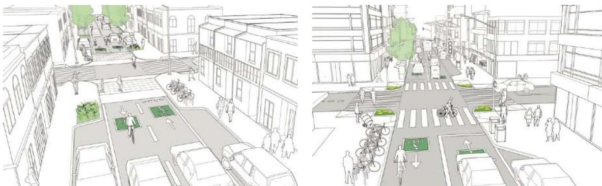
Figura 48 - Exemplos dos estreitamentos, com e sem faixa de travessia elevada, propostos para as interseções da Zona 30
