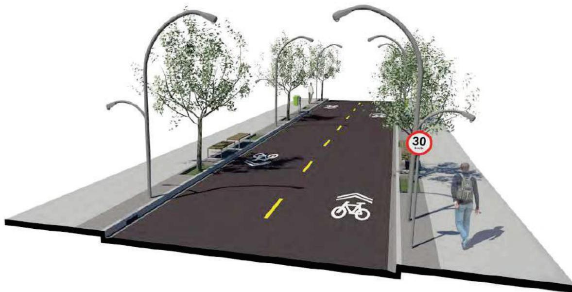
Figura 23 - Sinalização do tipo sharrow, indicada para ciclorrotas
