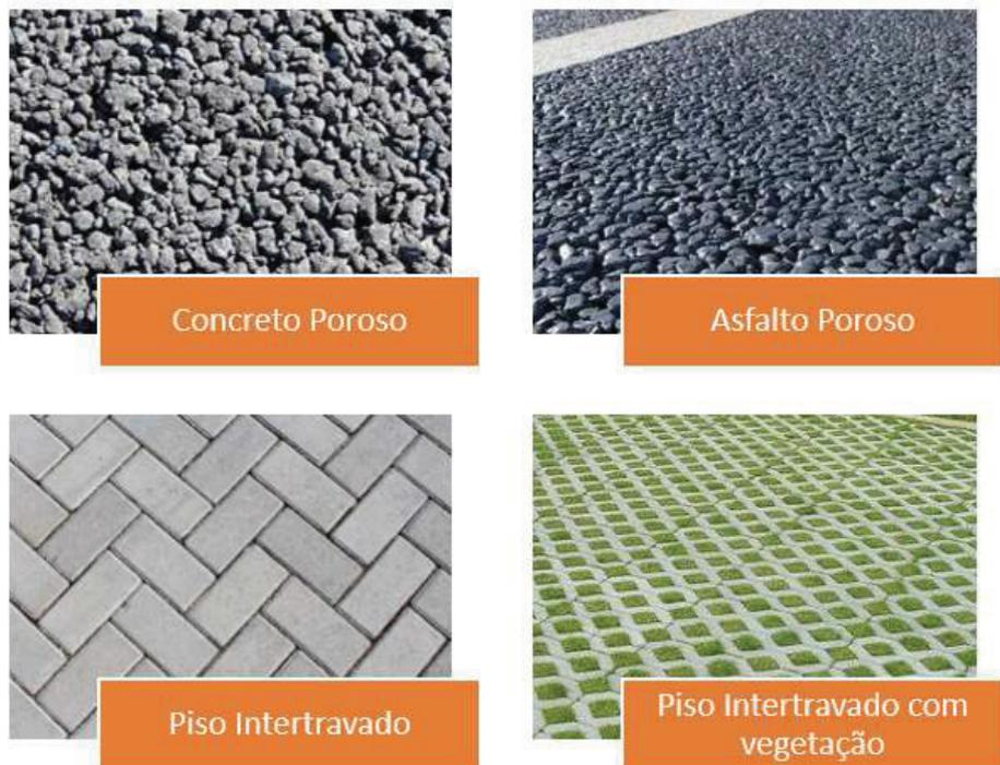
**Figura 44 – Tipos de pavimentos permeáveis**
