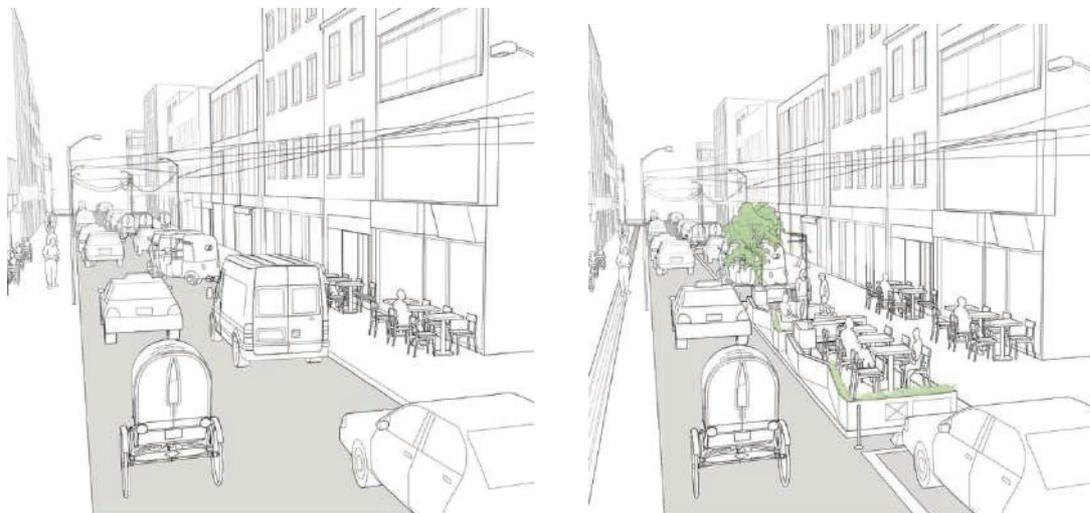
**Figura 9 – Exemplo de remodelação de via a partir de implantação de Parklet**
