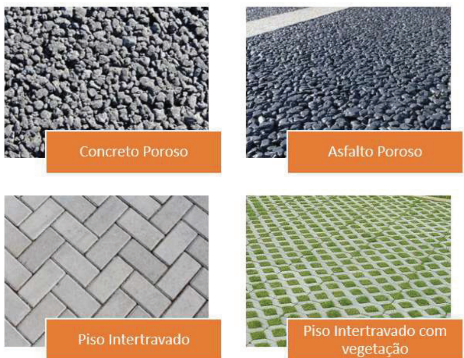
Figura 44 – Tipos de pavimentos permeáveis Fonte: Aguiar (2022)
