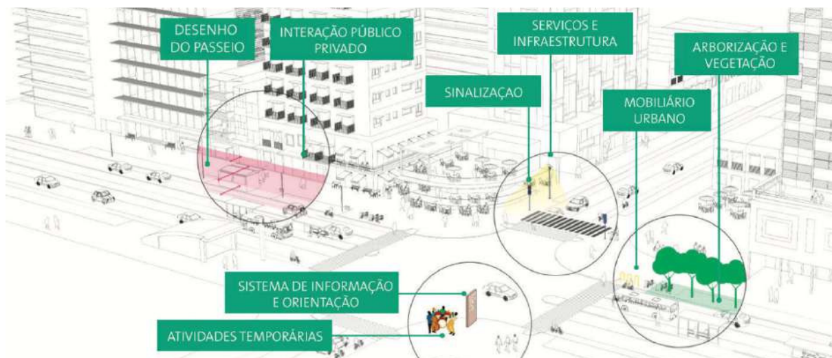
Figura 2 - Exemplo espaço público pensado a partir da priorização do transporte ativo. Fonte: BID, MDR (2020b, p. 37)
